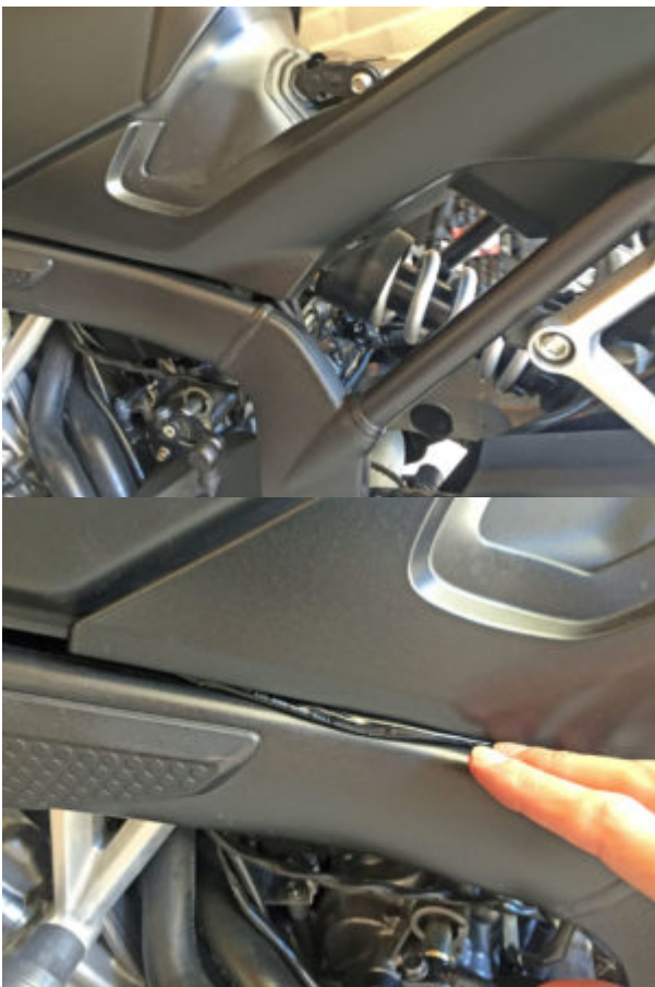
Passage du câble le long du cadre
