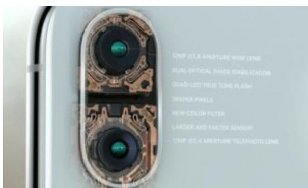
Double-optique stabilisée d'un iPhone
